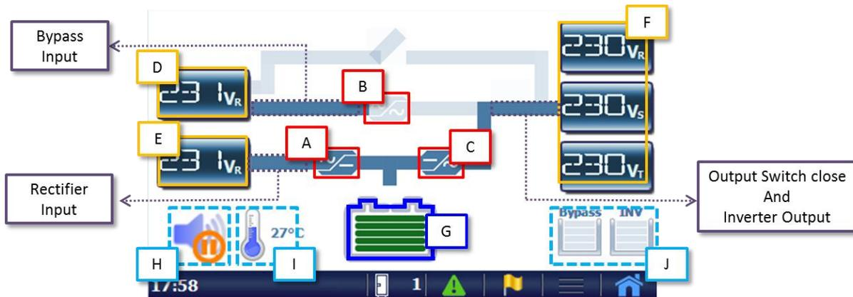
【A】 is Rectifier 、 【B】 is Static Switch and 【C】 is Inverter.
